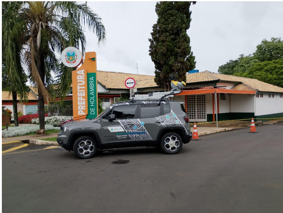
Figura 34 - Veículo do Mapeamento Móvel Terrestre 360°.
