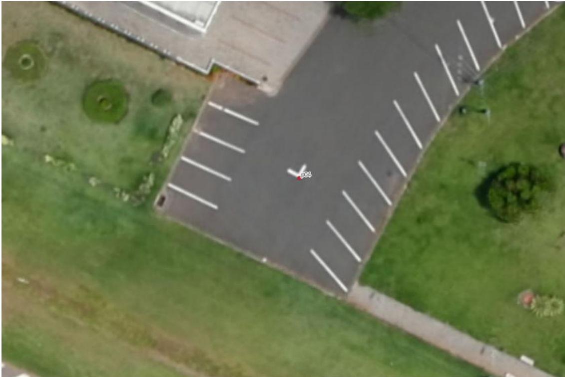
Figura 35 - Exemplo de pontos de apoio (tie points).
