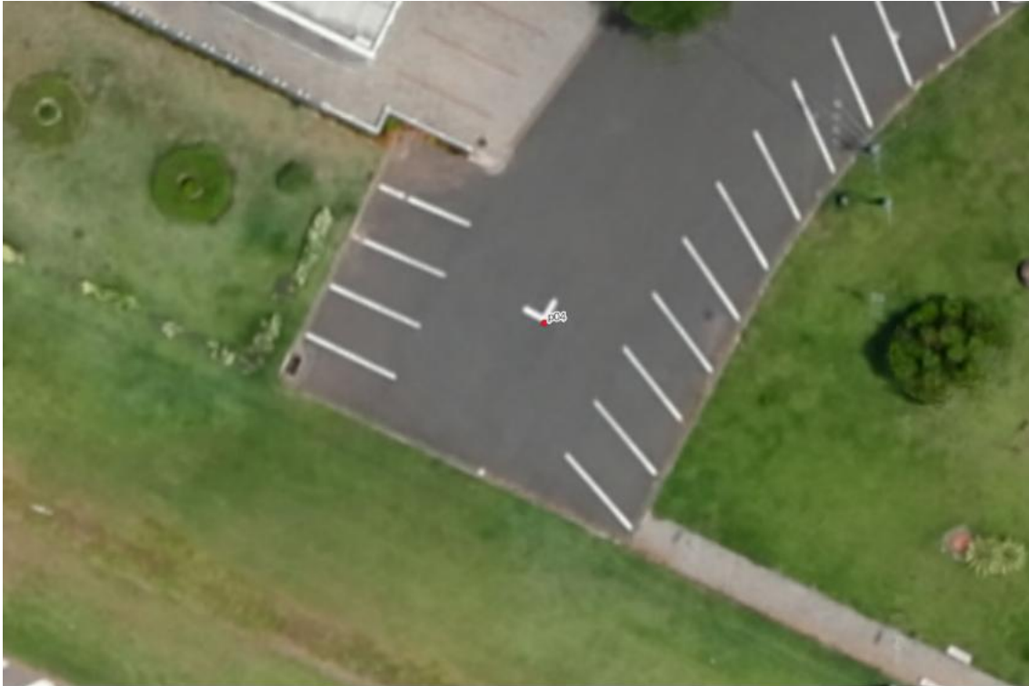
Figura 27 - Exemplo de pontos de apoio (tie points).
