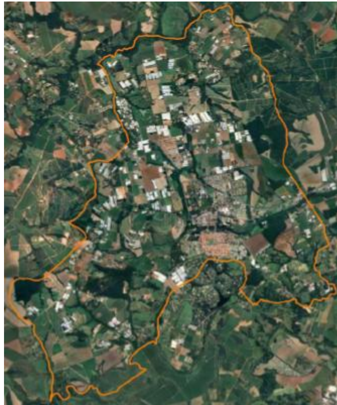
Figura 11 - Planejamento do Limite de Voo - GSD 10cm
