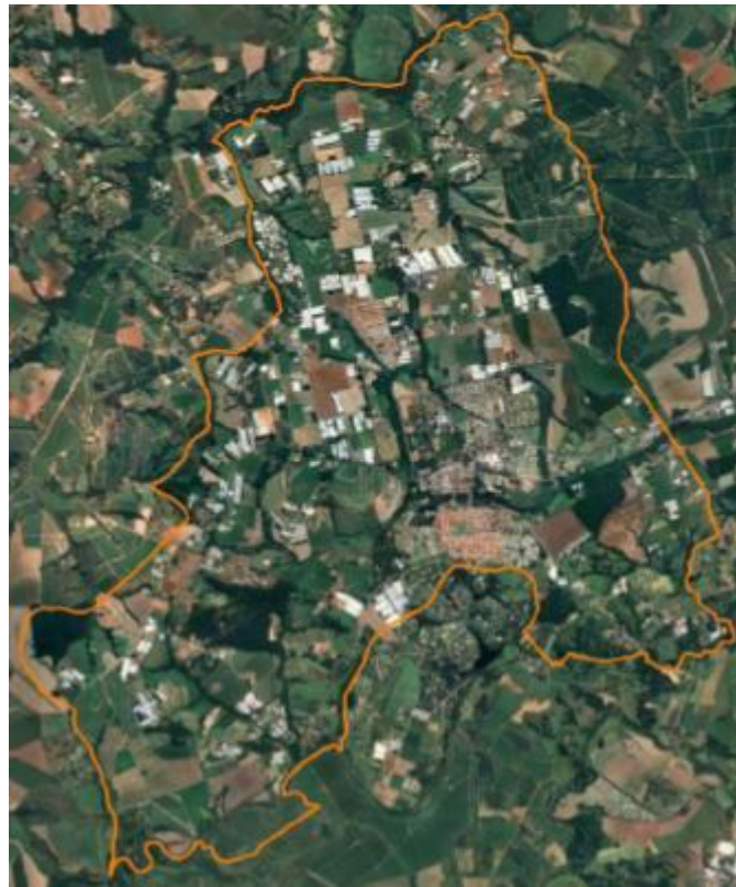
Figura 31 - Planejamento do Limite de Voo - GSD 10cm
