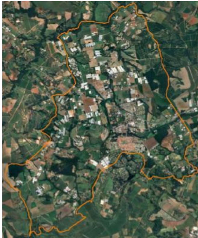
Figura 17 - Planejamento do Limite de Voo - GSD 10cm
