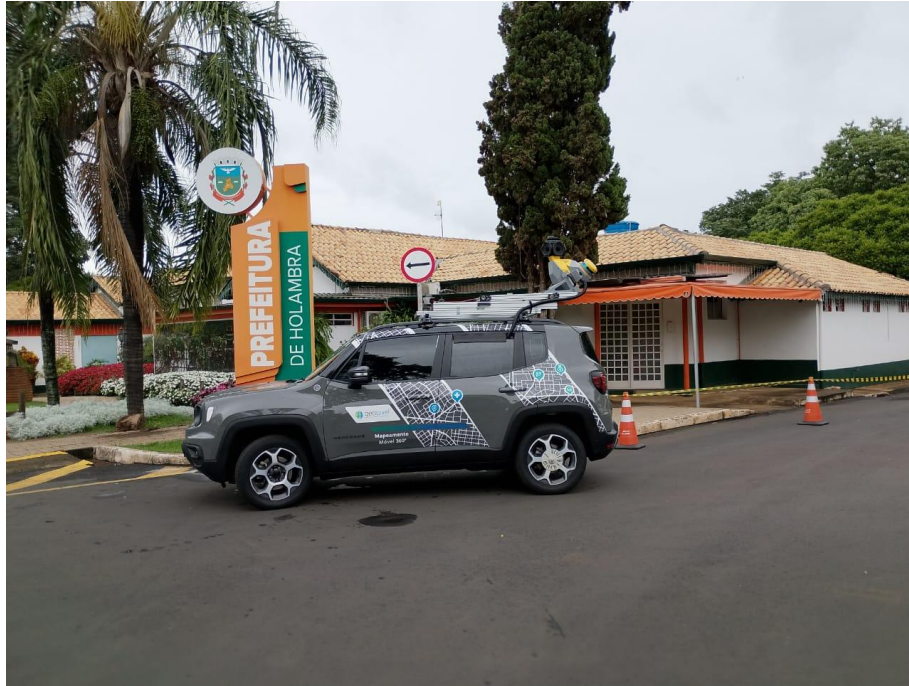
Figura 40 - Veículo do Mapeamento Móvel Terrestre 360°.
